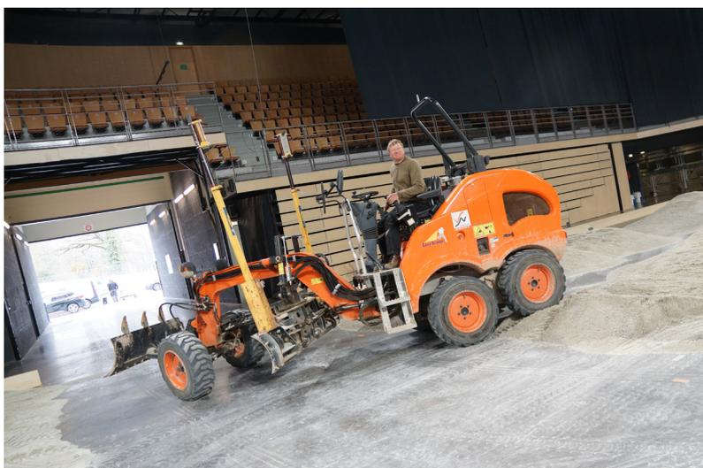
Avec une hauteur de seulement 2 mètres, une fois l'arceau de sécurité replié, la niveleuse Easy-Grader permet de rentrer facilement dans des bâtiments pour des chantiers indoor. Comme par exemple, lors de la finale de la Coupe de France de pétanque au Vendéspace.
